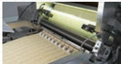
仕上がっためん帯を、切り出し機にかけます。切刃が回転して、めん帯はめん線になります。中華めんの多くにウエーブがかかっているのは、波形を作る装置と補助コンベアーによるものです。
